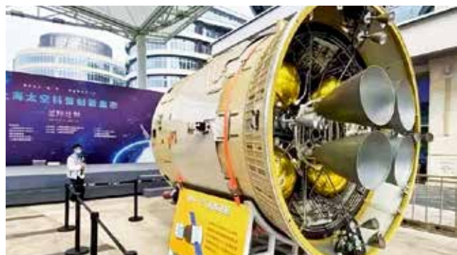
神舟载人飞船用的推进分系统主承力薄壁加筋截锥，是我国载人航天史上首次使用的大型碳纤维复合材料制品
